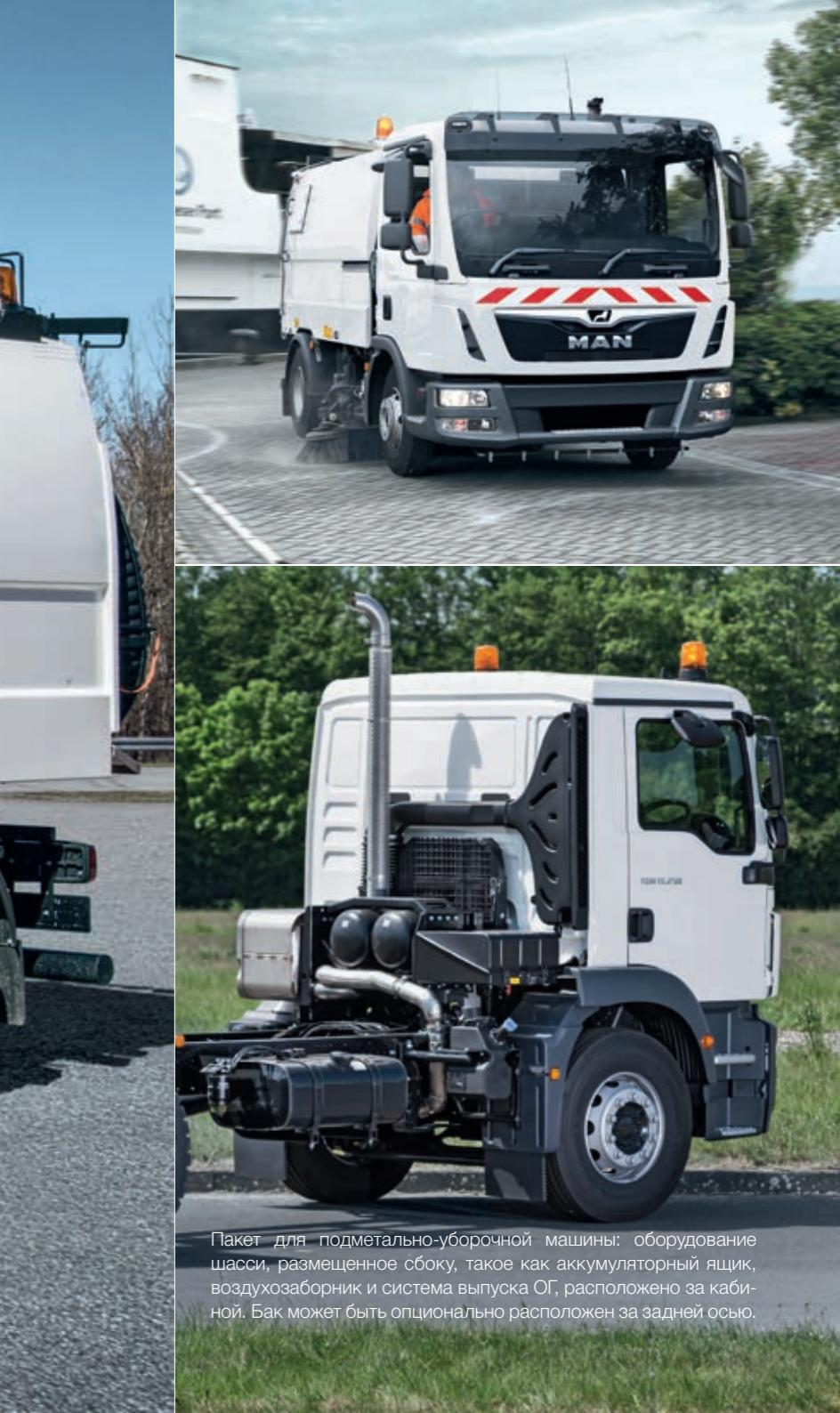
Пакет для подметально-уборочной машины: оборудование шасси, размещенное сбоку, такое как аккумуляторный ящик, воздухозаборник и система выпуска ОГ, расположено за кабиной. Бак может быть опционально расположен за задней осью.
