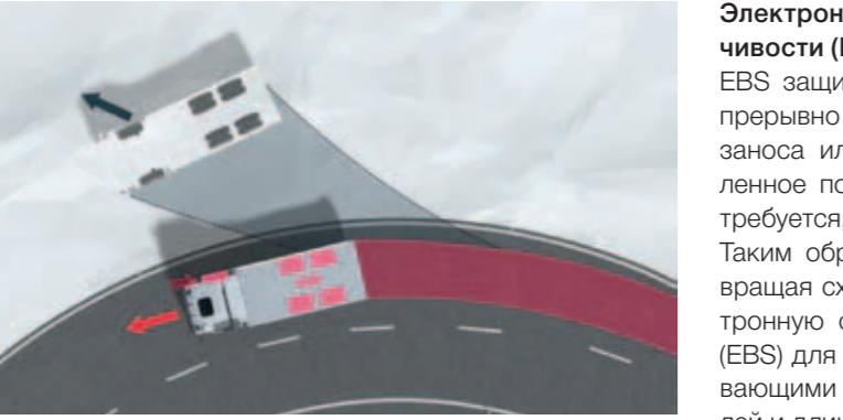
Вмешательство EBS при избыточной поворачиваемости автомобиля
